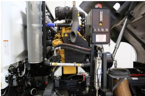
Die in der VS4 verbauten Cat C2.2 Motoren entsprechen der Abgasstufe EU V.
